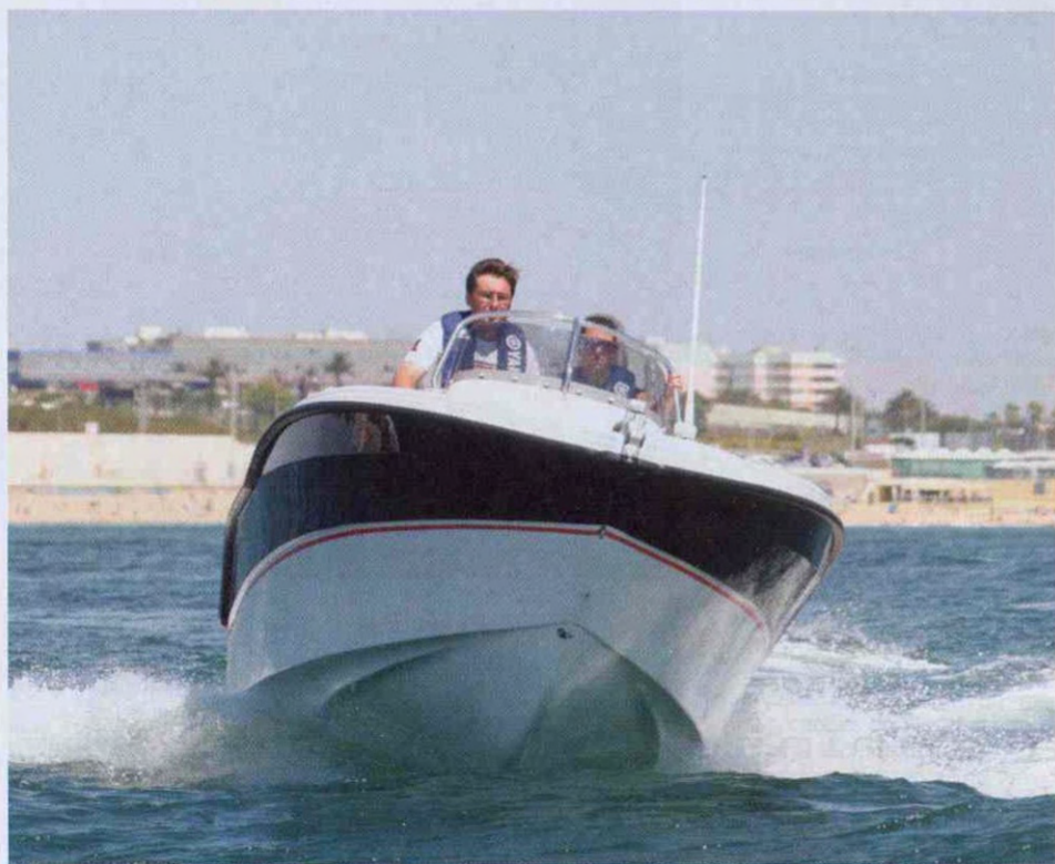
O Levant 560 Open tem um novo casco, que é inafundável e tem um V evolutivo bastante marcado com robaletes muito salientes
