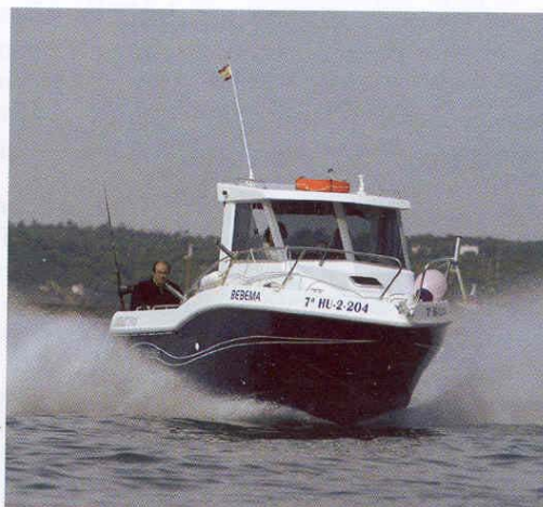
O casco bem desenhado para o mar consegue deflectir a água para longe, evitando os salpicos
